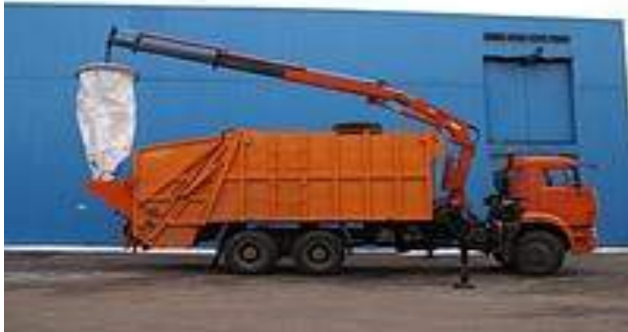
Рис. 4.4. Мусоровоз с манипулятором Amco Veba 810-2S на шасси КамАЗ-6511
